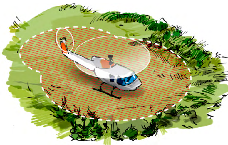
Figur 20. Riskzonen är 5 meter utanför yttre änden på rotorerna. Illustration: Per Hardestam.
