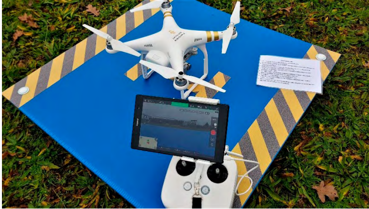
Figur 21. Exempel på ett flygsystem (UAS). Foto: Stefan Haggö.
