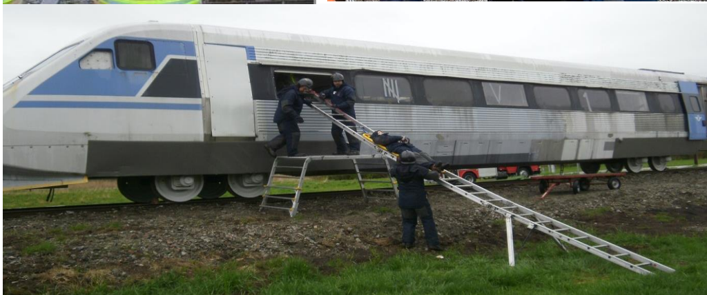
Figur 26. Det blir ofta höga lyft när den drabbade ska ner från vagnen, bland annat beroende på höga banvallar. Vid dörröppningen är stege ett mycket bra hjälpmedel. Låt baren kanna ner på stegen (nedre bilden). Lakan, slynga eller spännband kan användas för att kontrollera nerfärden och motverka att den drabbade glider ner från baren. Denna teknik besparar räddningspersonal från onödiga lyft ifrån hög höjd och reducerar behovet av personal.
