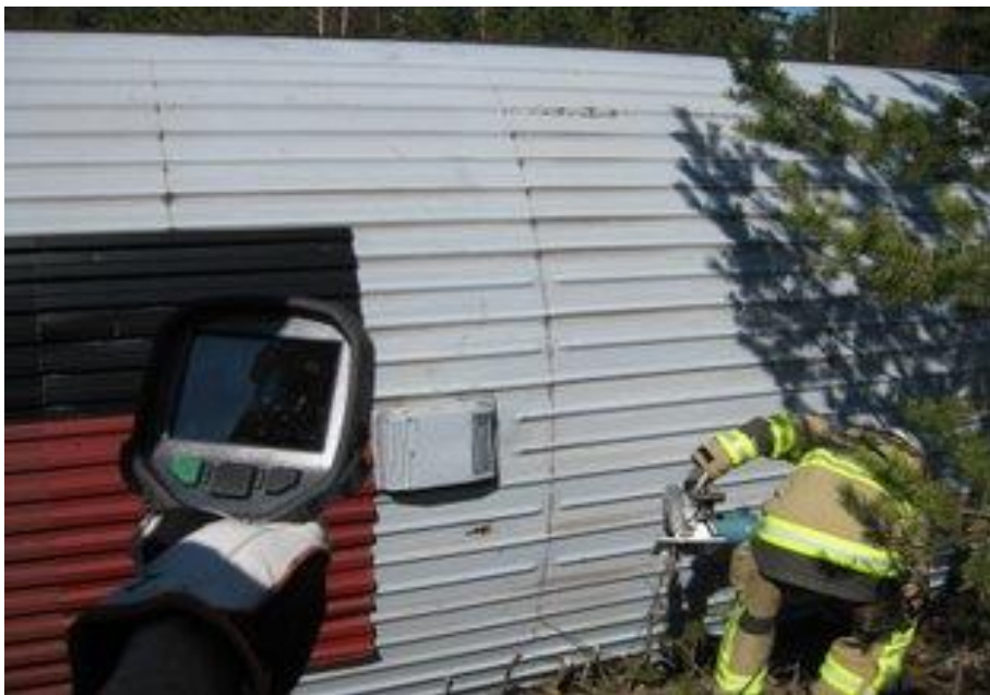
Figur 19. Användandet av IR kamera för att urskilja balkar.
