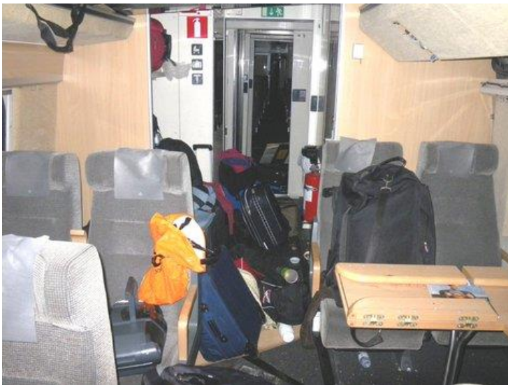
Figur 6. Vid tågkraschen i Kimstad, 2010, ramlade bagage ner från hyllorna, vilket försvårade framkomligheten vid räddningen och bidrog till skador.
