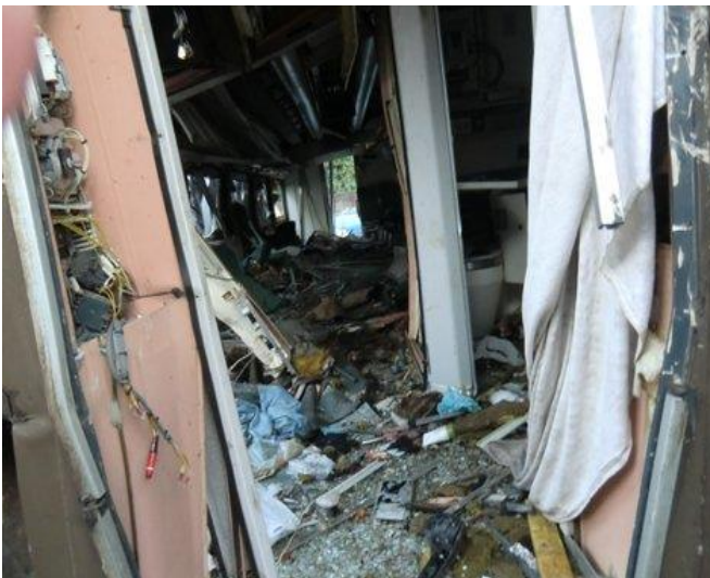
Figur 8. Inredning slets loss även i denna vagn och illustrerar hur det kan se ut. ( https://sv.wikipedia.org/wiki/J%C3%A4rnv%C3%A4gsolyckan_i_Santiago_de_Compostela )
