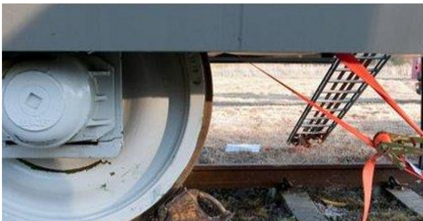
Figur 11. Exempel på säkring av tågagn; spännband fästs mellan boggi och räls.
