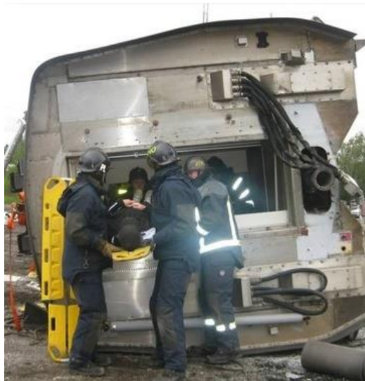
Figur 25. Placera en stege på sätena och låt baren glida på stegen och sedan ut genom dörren.
