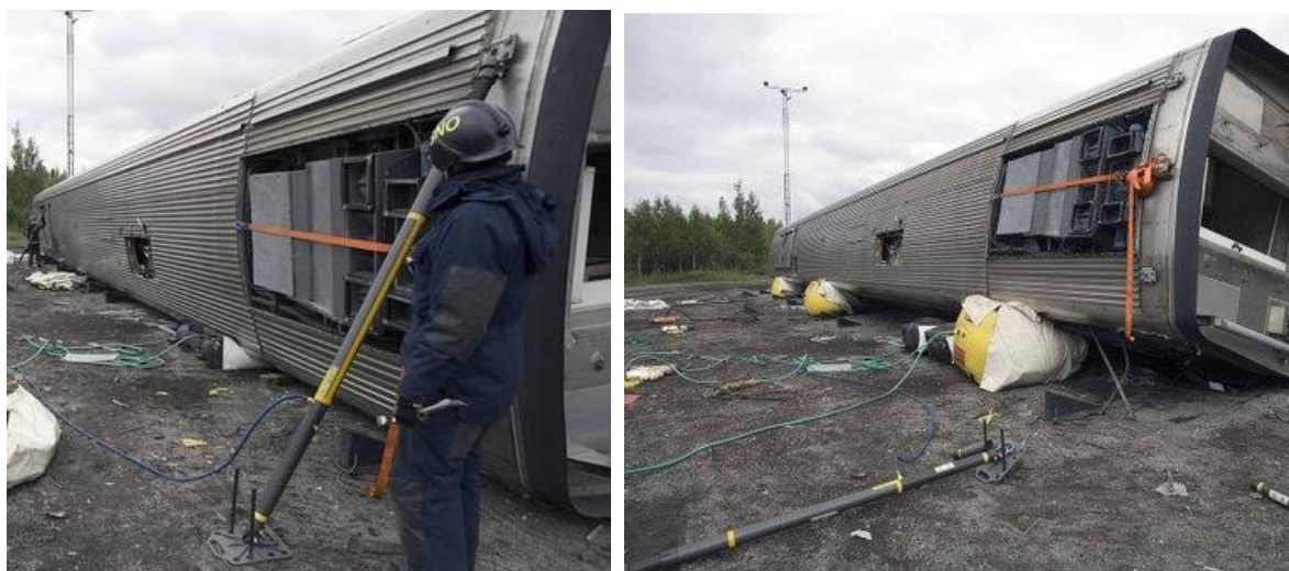
Figur 21. Användning av lyftkuddar för att frigöra fastklämda personer under en vagn. Först kan man börja med mindre kilkuddar för att med dem lyfta vagnen lite, så att man får in de större lyftkuddarna.
