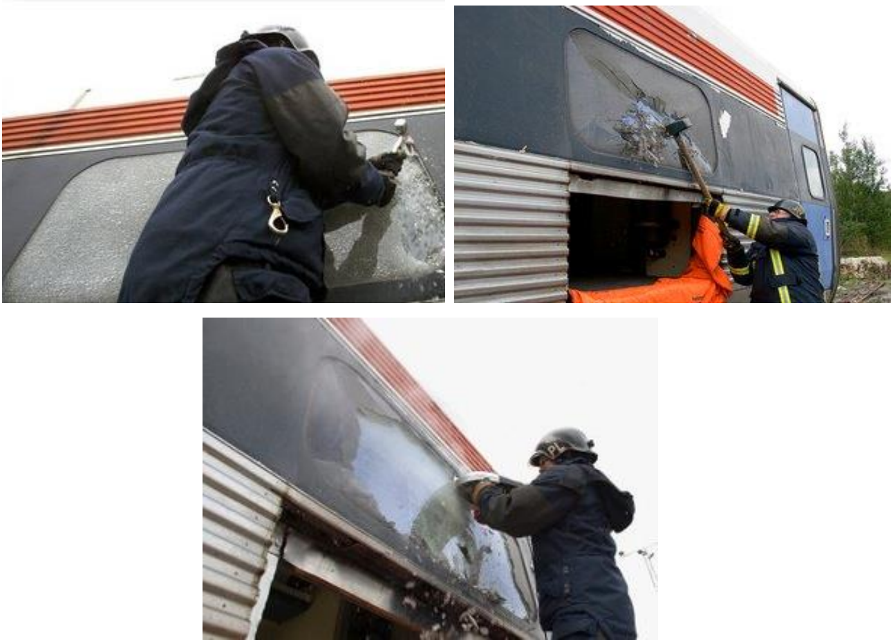
Figur 17. Tillträde genom fönster. Det yttre lagret glas är oftast sk. härdat glas som kan krossas med hammare eller slägga, medan det inre lagret är av laminerad typ (som framrutan på en bil) och denna sågar man lämpligen igenom.
