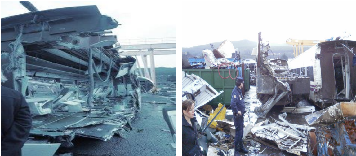
Figur 7. Tågurspårningen utanför Santiago de Compostela, Spanien, 2013. En bidragande faktor till de stora skadorna på vagnen var den skarpa kanten på vattenrännan som var placerad längs med spårets ytterkurva och som slet upp hela sidan av vagnen. All inredning lossnade när vagnens sida revs upp i en av vagnarna vid kraschen.
