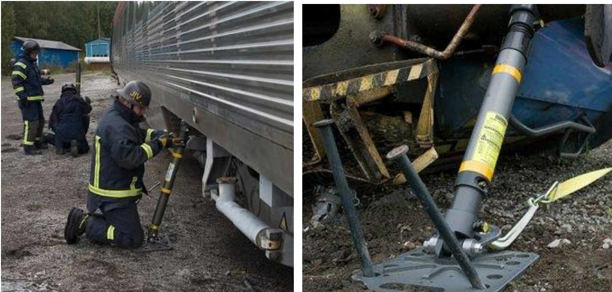
Figur 13. Stabilisering med hydraul-stötta som anbringas mot förstärkt lyftpunkt på vagnen. Plattan mot marken spikas fast enligt bild.
