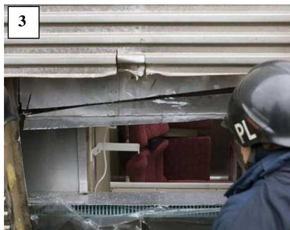
Figur 20. Hål i taket tas upp enligt "flerskiktprincipen" där man försiktigt arbetar sig igenom de olika materialen med lämpligt verktyg. Placera säkerhetsperson på insidan som markerar var tillträde skall skapas och markera exempelvis med borr var hålet kommer att bli. Hydraulverktyg är att föredra för avlägsnande av balk (bild 2). Här har man öppnat upp genom flera skikt (bild 3) och så småningom har man nått igenom (bild 3). Observera att öppningen bör göras tillräckligt bred för att underlätta evakuering från trångt inre utrymme. Beakta hatthyllan och eventuella andra strukturer som kan vara i vägen och skydda vassa kanter (bild 4).
