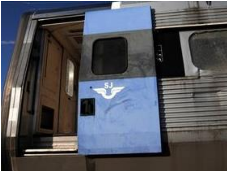
Figur 16. Tillträde via dörr är oftast bästa vägen när man har att hantera vagnar stående på hjulen.
