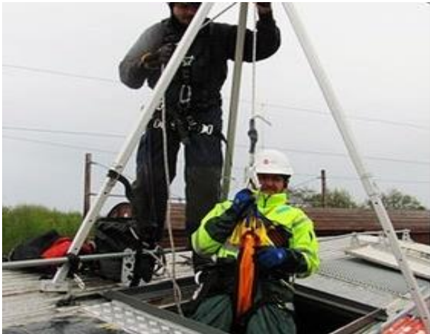
Figur 29. Evakuering från liggande vagn via fönster högst upp. Efter håltagning i fönstret, sänks en stege ned enligt bilden överst till vänster. På denna kan baren med den drabbade dras upp, för att i nästa steg sänkas ner från taket på en glidbana av kopplade stegar som på bilden överst till höger. I speciella fall när det finns tillgång till s.k. tripod och tränad räddningspersonal kan istället denna metod användas (undre bilderna).
