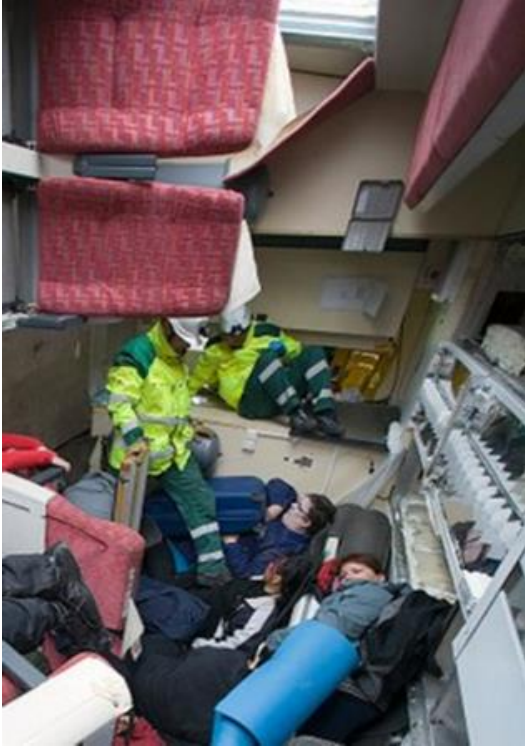
Figur 5. Bilden illustrerar hur det kan se ut i en vagn som lagt sig på sidan. Observera fallhöjden som kan vara upp till tre meter för vissa åkande.
