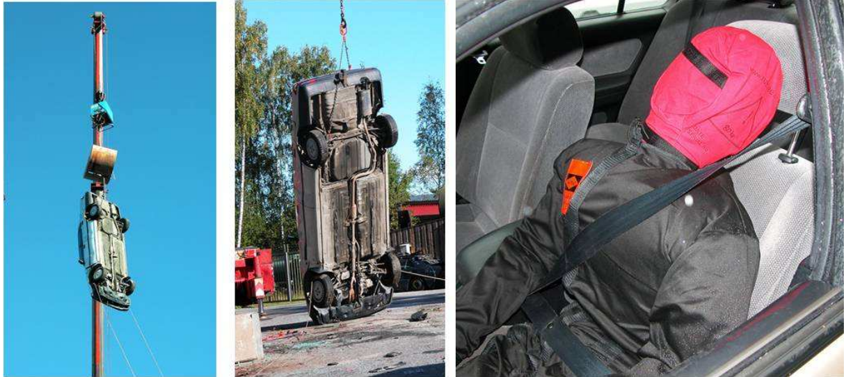
Figur 1. Metod för deformation av bilarna från 30 meters höjd med 80 kg:s bältad förare.
