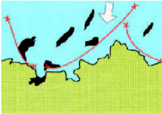
Styrande länsning från land med styrning till vrakvik eller annat strandavsnitt som kan "offras".
