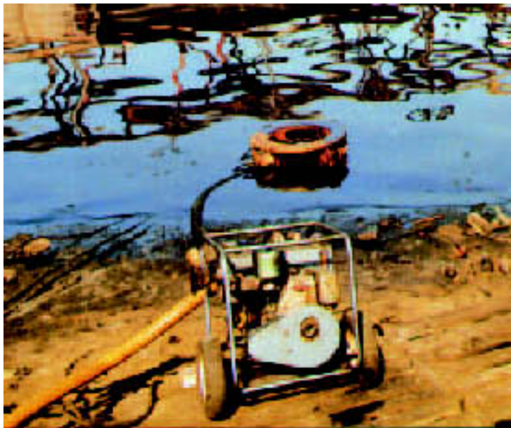
Komara 12K med hydrauldrivning och Spatepump. [Foto: Vicoma]
