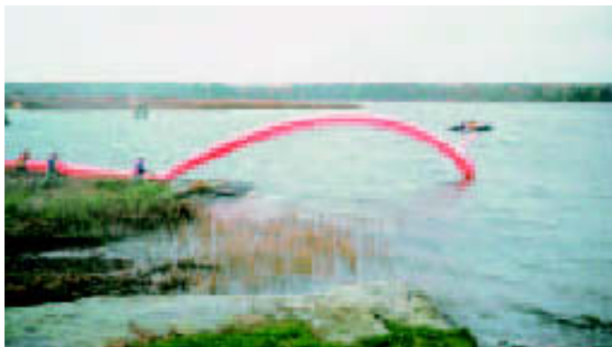
Utläggning av lättviktslänsa i hård vind. Stora lyftkrafter kan uppstå om länsan planar och lyfter så att vinden kan omströmma länsprofilen. [Foto: Björn Forsman, SSPA]
