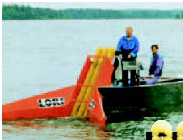
Roterande borstband i en småskalig konstruktion för mindre arbetsbåtar. [Foto: LORI]
