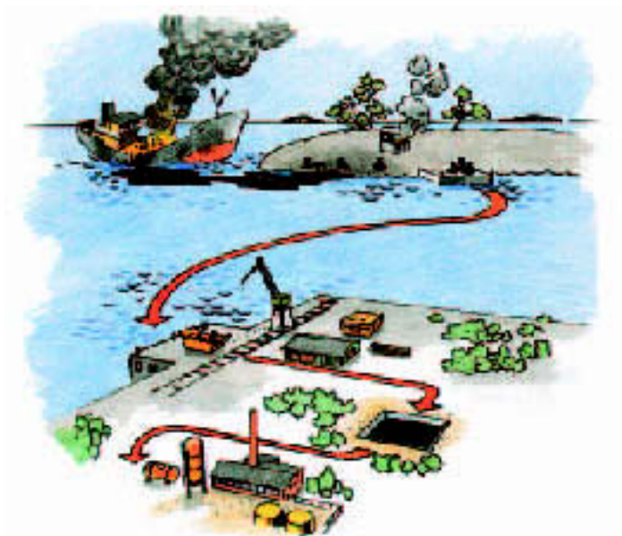
Transportkedjan från upptagningsplats till slutbehandling. [SNV rapport 3169 HOBOS, illustration av Mikael Jansson]
