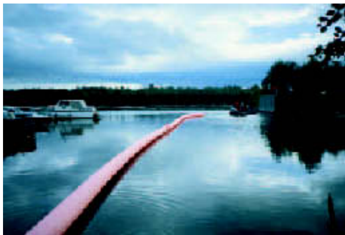
Vind och vågor påverkar länsans lutning och egenskaper. Här en lättviktslänsa utlagd i lugnt väder. [Foto: Gustav Törling, SRV]
