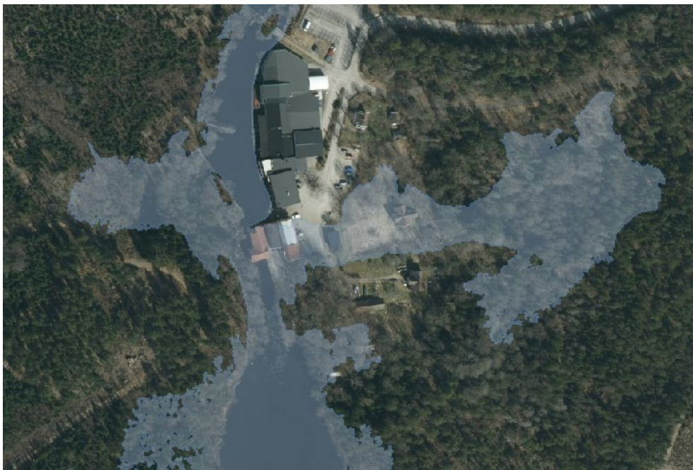
Figur 3 Exempel på karterad översvämning (blått område) runt dammen Dång vid Dångeborås vid 50-årsflöde. Hus i dammens direkta närhet visas som översvämmade.
