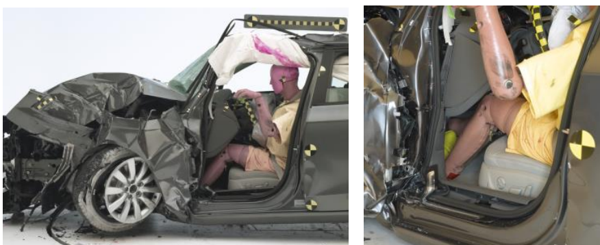
Figur 37. Small-overlap prov med 2012 Audi A4 (MLB plattform)
