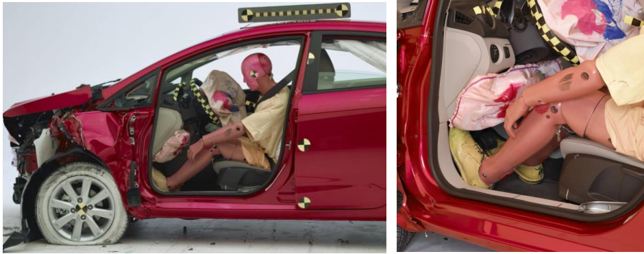
Figur 34. Deformationer i ett test med en 2011 Ford Fiesta.
