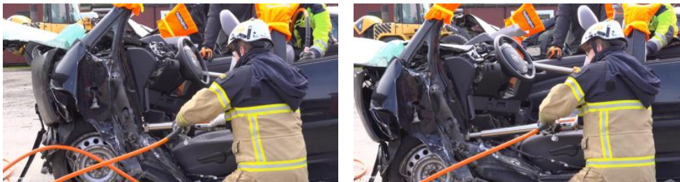
Figur 58. Bildserie av två bilder som illustrerar mittcylindermethoden.
