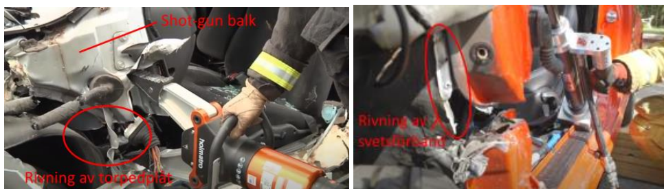
Figur 53. Två exempel på torpedväggens deformation. Rivning av plåt samt rivning av svetsförband. Den sistnämnda vid rotering av instrumentbräda.
