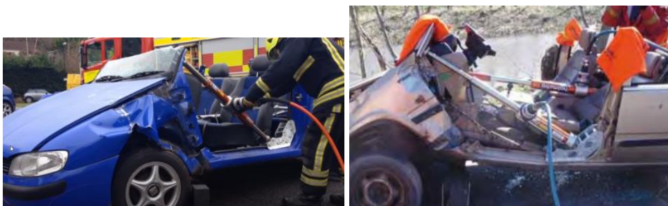
Figur 56. Rotering av frontparti vid rotation av instrumentpanel.
