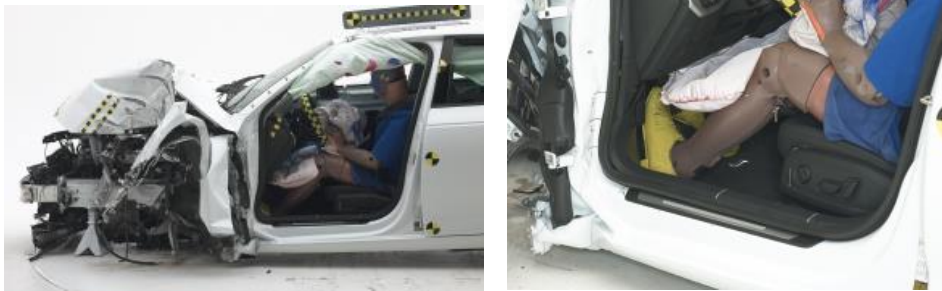
Figur 38. Small-overlap prov med 2017 Audi A4 (MLBevo plattform)
