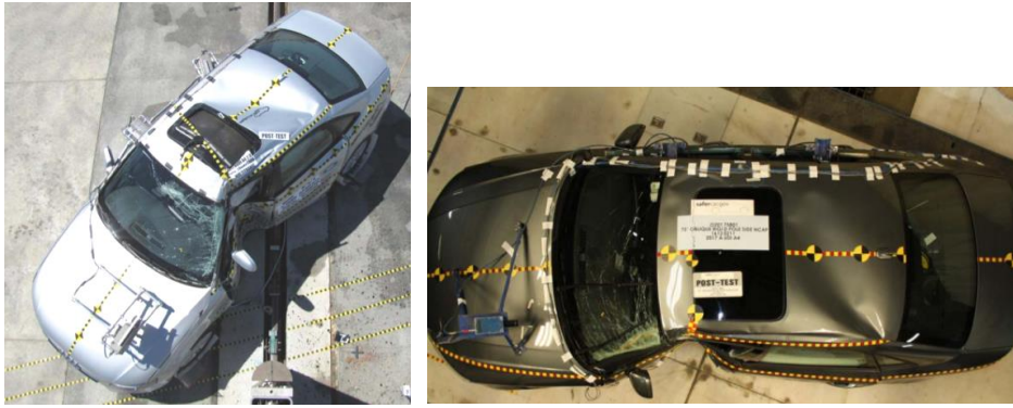
Figur 47. Resultat av stolpkollision med två generationer Audi A4, 2011 (MLB plattform) till vänster och 2017 (MLBevo) till höger.
