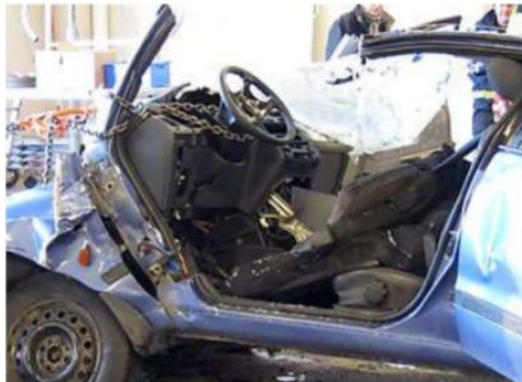
Figur 60. Deformation av karossen med dragmetoden.
