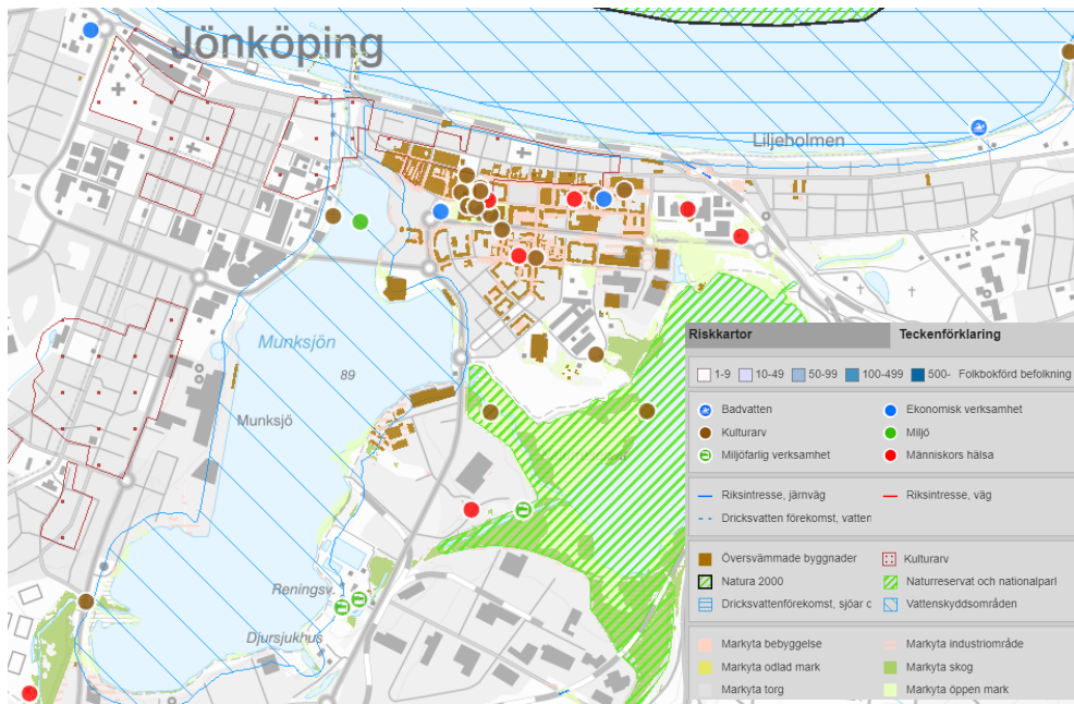
Figur 13. Riskkarta i Jönköping till följd av beräknat högsta nivå (BHN) i Vättern.
